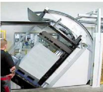
2. Vollautomatischer Systempalettenspender für den Stapelwender
