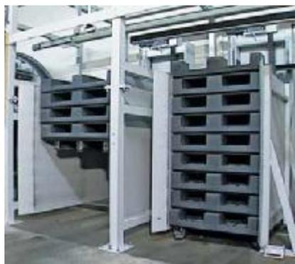
3. Dreheinrichtung zum Änderungsverlauf der Paletten. Die Einrichtung kann auch Höhenunterschiede des Bodens mit einer Liftbewegung überbrücken
