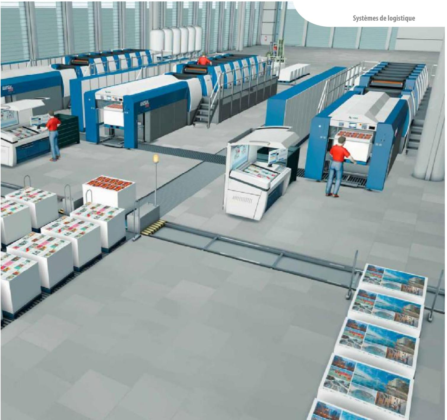
4. La pile est transférée du convoyeur sur le chariot de transport autoguidé qui l'achemine jusqu'à la destination prévue. La destination peut être indiquée par un code EAN
